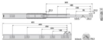
Guide con sfere con estrazione totale in acciaio zincato. Guida in altezza 45 mm. Si fissa al lato del mobile mediante viti (non incluse) e dispongono
