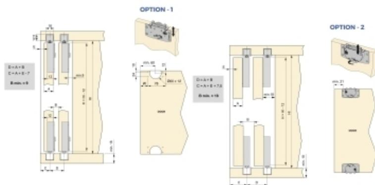
Sistema scorrevole Flow 2 con kit per ante in legno supportate. Questo kit include tutti gli accessori necessari per installare un armadio a 2 ante tr
