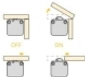
Interruttore per accendere e spegnere le lampade in modo automatico con l'apertura e la chiusura dell'anta. In questo modo l'illuminazione si accende quando si apre l'anta e si spegne quando si chiude l'anta.
