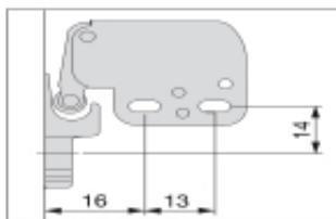
La chiusura a pressione Fast Latch per mobili si regola con un fermo meccanico trattenendo l'anta al mobile. Possiede un cuscinetto di gomma che mantiene
