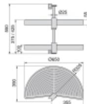
Cestelli girevoli mezza luna progettati per ottimizzare lo spazio in moduli ad angolo di cucina a forma di L. Sono facili da installare e adattabili
