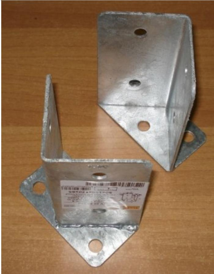
Portapilastro d'angolo in ferro zincato a fuoco, venduto a coppia. Dimensioni Base mm 65 x 120; Dimensione Angolo mm 80 x 80 x H 150. Spessore mm 3.
