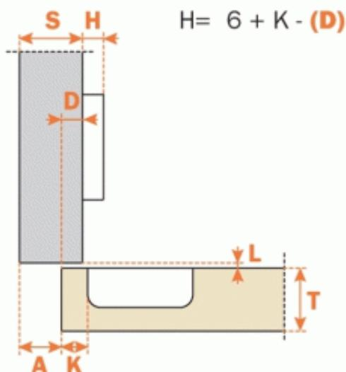
Per montaggio ante a 1/2 filo esterno. - Foro su anta mm. 35. - Profondità della scatolina metallica 11 mm. - Apertura 110°. - Possibilità di foratura dell'anta 'K' da 3 a 6 mm. - Adattabili a tutte le basi tradizionali Serie 200, e a tutte le basi a innesto rapido.
