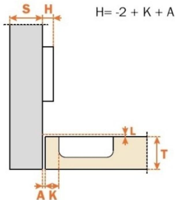
Per montaggio ante a filo interno. - Foro su anta mm. 35. - Profondità della scatolina metallica 11 mm. - Apertura 110°. - Possibilità di foratura dell'anta 'K' da 3 a 6 mm. - Adattabili a tutte le basi tradizionali Serie 200, e a tutte le basi a innesto rapido. Basetta non compresa
