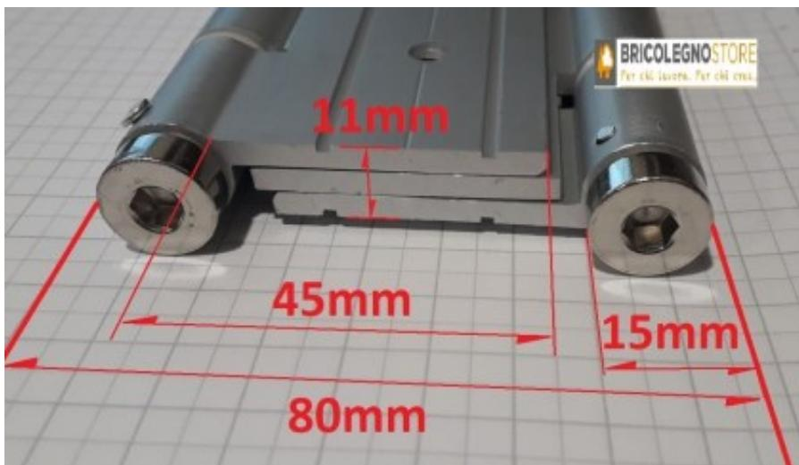
**CERNIERA A MOLLA DOPPIA AZIONE** Corpo in alluminio, perni tubolari in acciaio inox, lamelle di torsione in acciaio per molle Chiude la porta automaticamente Potenza di chiusura regolabile Materiale: Alluminio Altezza: 180 mm Capacità di carico con 2 cerniere: 35 kg
