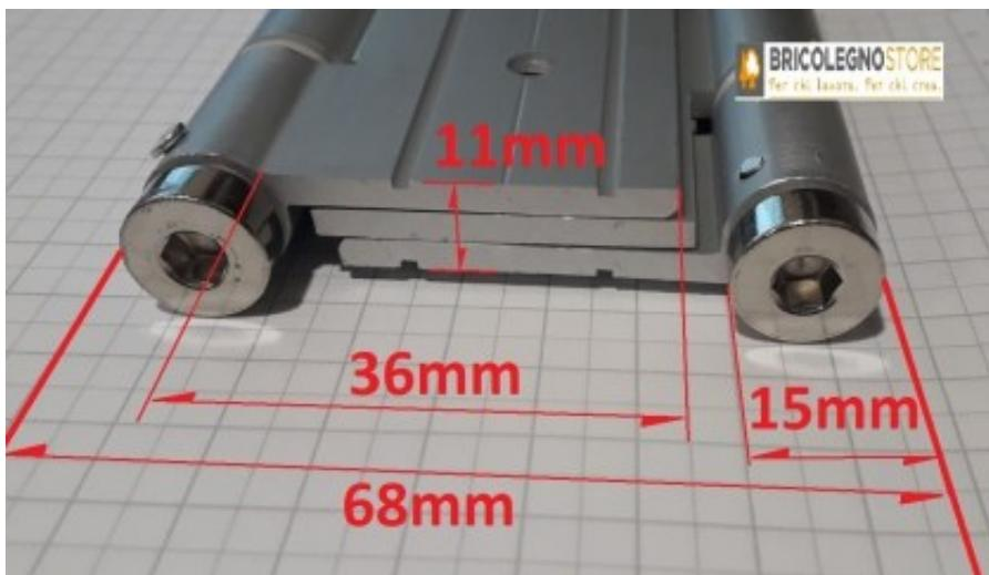
**CERNIERA A MOLLA DOPPIA AZIONE** Corpo in alluminio, perni tubolari in acciaio inox, lamelle di torsione in acciaio per molle Chiude la porta automaticamente Potenza di chiusura regolabile Materiale: Alluminio Altezza: 120 mm Capacità di carico con 2 cerniere: 20 kg
