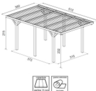
Carport Singolo Con Copertura Realizzato in legno di Abete lamellare, montanti sezione cm 12x12, Banchine laterali cm 12x4,5 Arcarecci cm 6x16. Coperture in perline mm 19. Guaina ardesiata inclusa.
