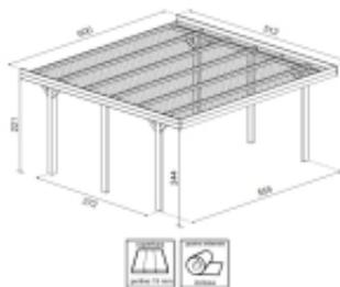
Carport Doppio Con Copertura Realizzato in legno di Abete lamellare, montanti sezione cm 12x12. Banchine laterali cm 19,5x7,50. Arcarecci cm 6x16. Coperture in perline mm 19. Guaina ardesiata inclusa.
