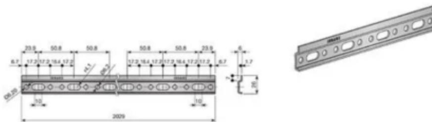
La barra reggipensile in acciaio zincato è ideale per il fissaggio a muro di pensili da cucina, librerie e scaffalature a muro in genere. Il prezzo è riferito per barra da 2 metri. Dettagli tecnici nell'immagine allegata
