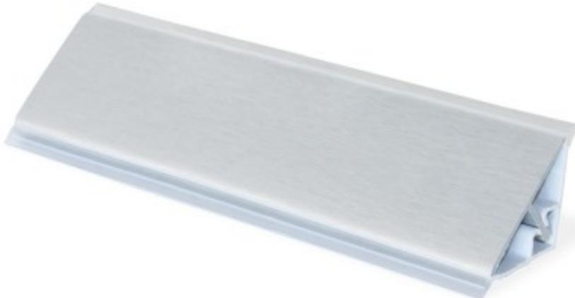
Disponibile in lunghezza cm 100, cm 200, cm 300 o cm 400. Usata per chiudere il top sulla parete della cucina evitando infiltrazioni. L' alzatina è provvista di un alloggiamento interno utile al passaggio di eventuali cavi elettrici. Struttura in PVC e frontalino in Alluminio
